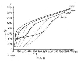
Wiederzündspannung U eines frei in Luft brennenden Lichtbogens von 40 A, 50 Hz, als Funktion der Zeit t bei Kupferelektroden
