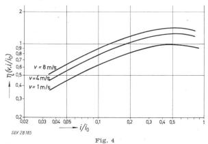
Hilfsfunktion  $\eta$  zur Berechnung der Charakteristiken rasch verlängerter Gleichstrom-Niederstromlichtbögen  $i_{\scriptscriptstyle 0}$  Strom bei geschlossenem Kontakt; i Momentanstrom; v Verlängerungsgeschwindigkeit  $U_B = \alpha + (l + \beta) \cdot \mathbf{E}(i) \cdot \eta(v, i/i_0)$
