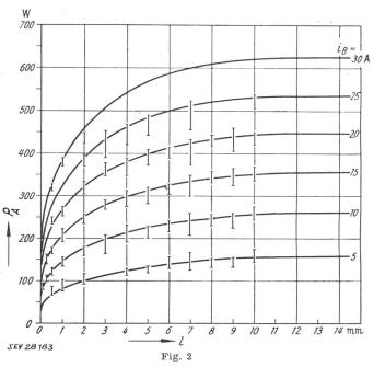
Von der Anode eines frei in Luft brennenden Gleichstrom-Lichtbogens aufgenommene Wärmeleistung  $P_A$  als Funktion des Elektrodenabstandes l bei Kupferelektroden
