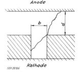
Zur Erläuterung des Übersteigens eines Lichtbogenfusspunktes auf eine andere Elektrode gleichen
