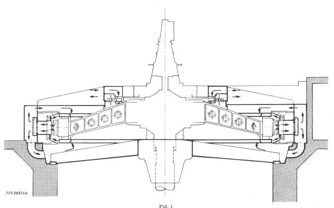
Typenzeichnung eines Generators des Kraftwerkes Birsfelden
