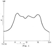
Tagesbelastungskurve eines Elektrizitätswerkes P Belastung
