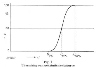
p Wahrscheinlichkeit; U Spannung;  $U_{0\%}$  Haltespannung;  $U_{50\%}$  50-%-Überschlagspannung;  $U_{100\%}$  100-%-Überschlagspannung
