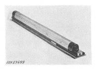
Heizstrahler befindet sich eine 8 mm dicke Glasfasermatte. Schutzgitter aus Streckmetall. Klemmen  $2\,\mathrm{P} + \mathrm{E}$  für die fest zu verlegende Zuleitung in seitlich angebautem Anschlusskasten. Länge 1000 mm, Breite 115 mm, Höhe 82 mm.
