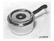
Der Boden hat bei der Formbeständigkeitsprüfung nur eine geringe Deformation erlitten. Solche Kasserollen sind daher für Verwendung auf elektrischen Herden geeignet.
