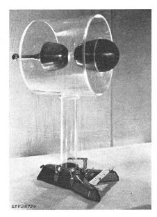
Elektrostatisches Hochspannungs-Voltmeter für Gleich- und Wechselspannung bis 5 MHz und bis 100 kV mit einer Klassengenauigkeit von 0,5
