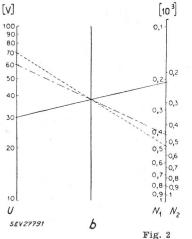
Nomogramme für die Berechnung von Gleich-Wechsel-Spannungswandlern
