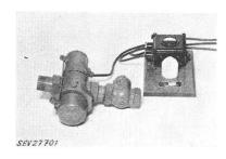
regerröhre und eine Elektrode eingebaut, wobei letztere über Widerstand und Kondensator am Nulleiter angeschlossen ist. Milliampèremeter, Widerstand, Kondensator und Anschlussklemmen in Verbindungsdose aus Isolierpreßstoff eingebaut. Signallampe vorhanden. Zuleitung Gummiaderschnur 2 P + E, fest angeschlossen.
