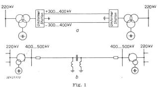
Energieübertragung mit Gleichstrom von ± 300...400 kV (a) und Drehstrom von 400...500 kV (b)
