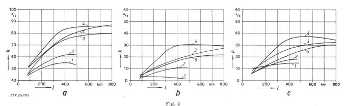
Für Gleich- und Umrichter verfügbare Ersparnisse aus der Gleichstromübertragung
