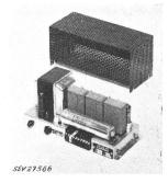
Photozellen dienen. Klemmen für Netzanschluss 2 P + E, ferner für die Lampen, Magnetventile zur pneumatischen Türbetätigung und Signaleinrichtungen. Kontaktbüchsen für die Photozellen. Prüf-Nr. 1 ist für 1 bis 3 Lichtstrahlen, Prüf-Nr. 2 für 4 bis 6 Lichtstrahlen gebaut.
