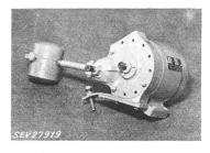
Die Schlagvorrichtung hat die Prüfung in sicherheitstechnischer Hinsicht bestanden. Verwendung: in trockenen und zeitweilig feuchten Räumen, für max. 500 V.
