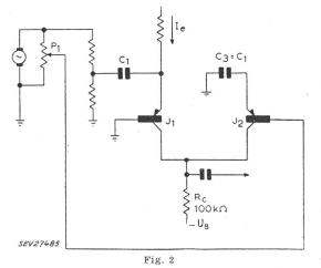
Strommodulator in Balance-Schaltung
