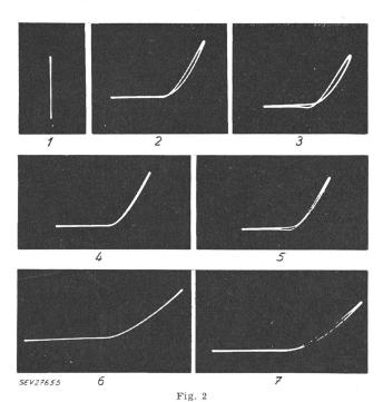
Dynamische Kennlinien dreier Germaniumspitzendioden je bei 100 kHz (2, 4, 6) und 600 kHz (3, 5, 7); 1 Strommaßstab 10 mA; Aussteuerungen oben und Mitte  $\hat{u}=1.0$  V; unten 1.77 V
