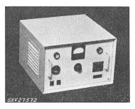
und Heiztransformator. Glimmlampen und Schalter an der Frontplatte. Zuleitung mit Stecker 2 P+E. Büchse für den HF-Ausgang. Verriegelungsschalter im Primärstromkreis. Störschutzkondensatoren vorhanden.
