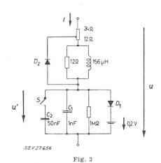
Vollständige Ersatzschaltung einer mittleren Germaniumflächendiode
