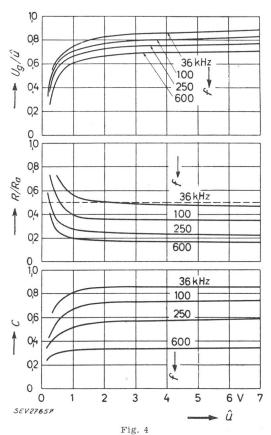
Spannungsrichtwirkung  $U_g/\hat{u}$ , normierter Dämpfungswiderstand  $R/R_{\hat{u}}$  und Eingangskapazität C eines Spitzenspannungsgleichrichters mit Germaniumflächendiode als Funktion der Aussteuerung  $\hat{u}$  bei verschiedenen Frequenzen
