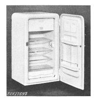
Ausschaltstellung. Glühlampe mit Türkontakt. Gehäuse aus lackiertem, Kühlraumwandungen aus emailliertem Blech. Zuleitung Gummiaderschnur mit Stecker 2 P + E, fest angeschlossen. Abmessungen: Kühlraum 860 × 420 × 420 mm. Kühlschrank  $1075 \times 635 \times 560$  mm. Nutzinhalt 126 dm<sup>3</sup>. Der Kühlschrank entspricht den «Vorschriften und Regeln für elektrische Haushaltungskühlschränke» (Publ. Nr. 136).
