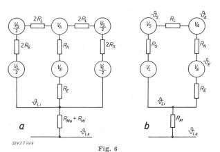
Wärmenetz einer geschlossenen Maschine mit Kühlröhren  $R_{\rm M}$  resultierender Widerstand zwischen innerer und äusserer Kühlluft
