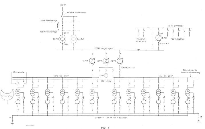
Schaltschema der elektrischen Anlage
