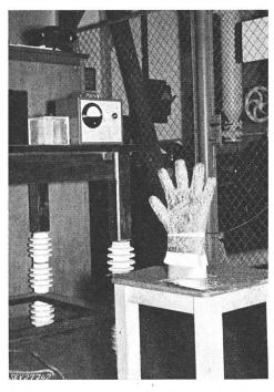
Fig. 4 Handschuh-Prüfeinrichtung für «Trockenprüfung» Hand-Hohlform aus gewickeltem Draht
