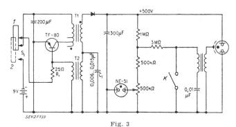
Schaltung eines Speiseteils mit Sperrschwinger für 30-Joule-Blitzgerät «Mecablitz 100» (Burleigh Brooks) 1 Ein-Stellung  $S_1$ ; 2 Aus-Stellung  $S_1$ ; K Kontakt
