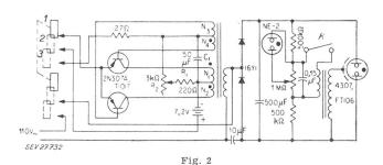
Schaltschema des Speiseteils mit Zündtransformator des 30-Joule-Blitzgerätes «Vanguard» (von Romal Electric)
