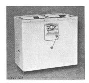
für Heizung. Zentrifuge und Pumpe zum Entleeren des Wäschebehälters oder der Zentrifuge, angetrieben durch je einen Einphasen-Seriemotor. Schalter für Pumpe und Zentrifuge, kombiniert mit Verschluss des Deckels. Signallampen eingebaut. Zuleitung Gummiaderschnur mit Stecker 2 P + E, fest angeschlossen. Handgriffe isoliert. Störschutzkondensatoren eingebaut.
