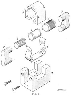
Die Einzelteile, aus denen der Transformator besteht 1 Steatitgehäuse; 2 Ferritkern; 3 innere Wicklung; 4 innere Abschirmung; 5 äussere Abschirmung und Wicklung; 6 Kernklammer; 7 Steatitbett
