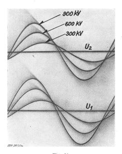
Kurvenformen der primären Niederspannung  $U_1$  und der sekundären Hochspannung  $U_2$
