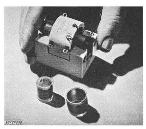
Fig. 1 Der Eingangs- und Ausgangstransformator des Verstärkers für das L3-Trägersystem
