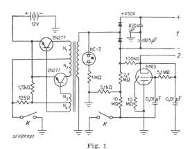
Schaltschema des Speiseteils mit Triggerröhre des 200-Joule-Elektronenblitzgerätes «Ascorlight» (American Speedlight) 6483 Kaltkathoden-Triggerröhre; NE-2 Signallämpchen, das aufleuchtet, sobald der Entladekondensator betriebsbereit aufgeladen ist; 1 900-V-Ausgang; 2 Triggerröhre; K Kontakte
