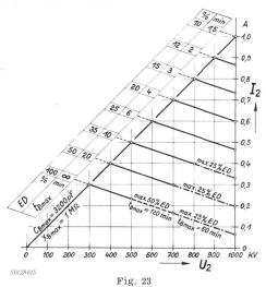
Zulässige Belastungsströme  $I_2$  des Transformators in Funktion der Hochspannung  $U_2$  bei verschiedenen maximalen Belastungszeiten  $t_{Bmax}$  und Einschaltdauer ED
