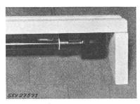
Der Heizkörper hat die Prüfung in sicherheitstechnischer Hinsicht bestanden. Verwendung: mit Belastung bis 260 W/m beheizte Länge.
