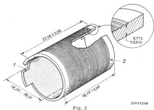
Die äussere Wicklung mit Dickeangaben des Spulenrohres
