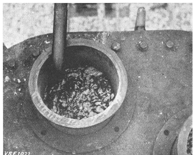
Fig. 4 Durch die Einführung von Stickstoff verursachte Turbulenz der freien Öloberfläche
