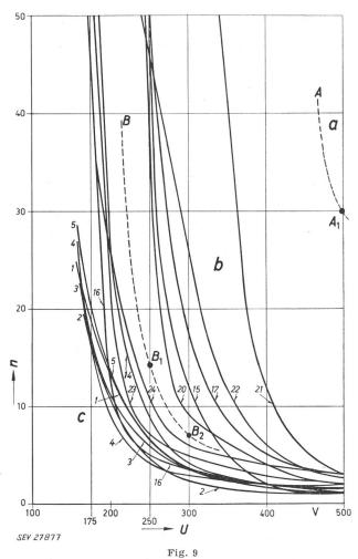
Grenztropfenzahl in Funktion der Prüfspannung für verschiedene organische Isolierstoffe, geprüft mit Tropfen von 10 mm³
