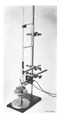
Fig. 1 Gerät für die Prüfung der Kriechfestigkeit nach der Tropfenmethode entsprechend dem Entwurf der CEI
