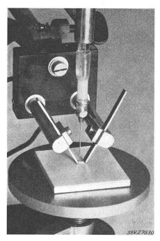
Fig. 2 Elektrodenanordnung und Tropfengeber des Kriechstromprüfgerätes
