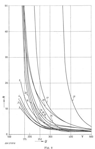
Grenztropfenzahl in Funktion der Prüfspannung für verschiedene organische Isolierstoffe, geprüft mit Tropfen von 20 mm³
