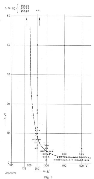
Bestimmung der Kriechwegfestigkeit an Preßstoff H.PAP (Phenolharz / 30 % Asbestpulver)
