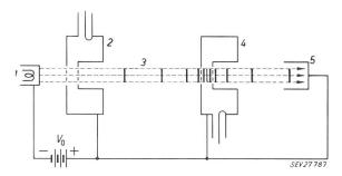
Fig. 2 Schema eines Klystrons
