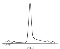
(3,3)-Absorptionslinie im Inversionsspektrum des NH $_3$   $f=23~870,13~\pm~0,02~$  MHz; Abstand der Satelliten von der Hauptlinie  $_{\pm}~1,7~$  und  $_{\pm}~2,3~$  MHz
