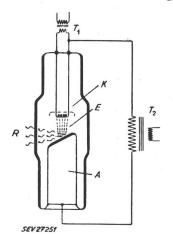
Röntgen-Röhre A Anode; E Elektronen; K Glühkathode; R Rönt-
