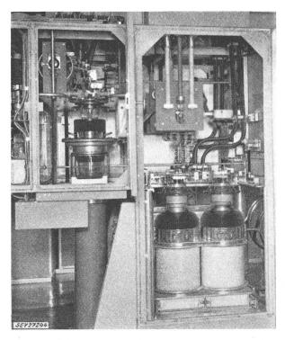
Fig. 10 Senderstufe mit 2 Senderöhren BR 189 (rechts)
