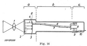
Image Orthicon (Orthikonoskop, Orthikon) 1 Linse; 2 empfindliche Photoelektrode; 3 Auftreffplatte; 4 Photoelektronen; 5 freigewordene Elektronen; 6 zurückkehrender Strahl; 7 Abtaststrahl; 8 Elektronenstrahlerzeuger; 9 Elektronenvervielfacher; 10 Ausgangssignal
