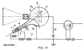
Image Iconoscope (Ikonoskop, Bild-Mosaikröhre) A Beschleunigungselektrode; C Kathode; G Steuerelektrode;  $P_a$  Kollektor (Auffangelektrode);  $P_c$  Photokathoden; R Lastwiderstand
