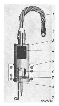
Fig. 21 Schnitt durch ein Ignitron
