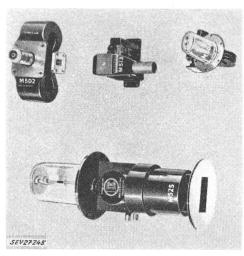
Fig. 11 Magnetron
