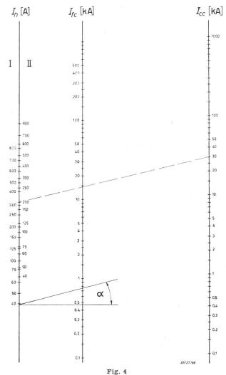
Fusible basse tension à haut pouvoir de coupure Courant de «limitation» (réellement coupé)  $I_{fc}$  en fonction du courant «présumé» (fusible shunté) de court-circuit  $I_{cc}$  de l'installation et du courant nominal  $I_n$
