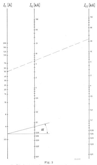
Fusible haute tension à haut pouvoir de coupure Courant de «limitation» (réellement coupé)  $I_{fc}$  en fonction du courant «présumé» (fusible shunté) de court-circuit  $I_{cc}$  de l'installation et du courant nominal  $I_n$
