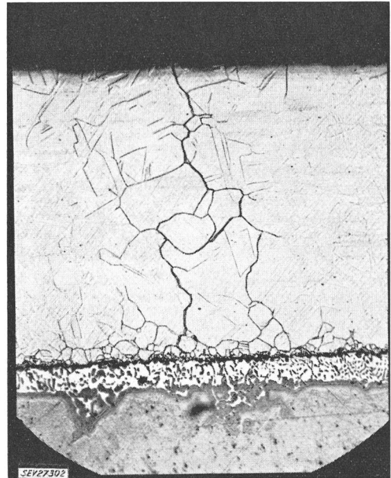
Fig. 2 Lotsprödigkeit bei «Kovar»-Blech Das Lot ist entlang den Korngrenzen ins Gefüge eingedrungen Vergrößerung 150fach
