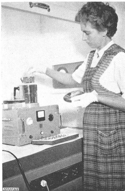
Fig. 9 Ultraschallbad zur Reinigung von Kathodenteilen
