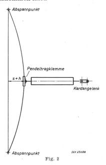
Zu diesem Zweck werden die Isolatorenketten mittels bekannter kardanischer Aufhängung nicht senkrecht, sondern in einem den Temperaturdifferenzen angepassten Winkel T schräg zur Seilachse angebracht (Fig. 1). Somit wird der Aufhängepunkt des Leiterseils am Tragmast um ein Abstandsmass,
