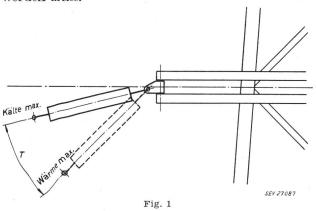
Zusatzgewichte bei solchen Leitungsprofilen sind deshalb stets ein unsicherer Notbehelf. Schon bei reiner Kettenentlastung, wahrnehmbar durch das bekannte Klappergeräusch der Isolatorenglieder und Armaturenteile, besteht bei starkem Wind die Gefahr einer unzulässigen Ketten- und Seilannäherung an die Mastteile.
