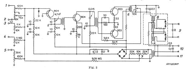
Schaltschema des Servoverstärkers für die Steuerung des hydraulischen Antriebs der Stabilisierungsflossen Die ersten Stufen des Verstärkers arbeiten mit Transistoren, während die letzte Stufe ein magnetischer Verstärker ist. Widerstände in  $\Omega$  bzw. in  $k\Omega$ , Kapazitäten in  $\mu F$  (wo nichts anderes vermerkt ist)
