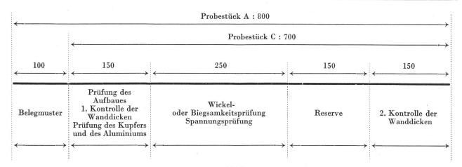
Fig. 1 Aufteilung der Probestücke A und C für die Prüfungen Masse in cm
