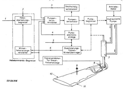
Fig. 1 Blockschema der elektronisch-hydraulischen Stabilisierungseinrichtungen für ein Ozeanschiff
