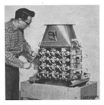
Fig. 1 Siliziumgleichrichter 800 kW für Lokomotive E 8001 der DB
