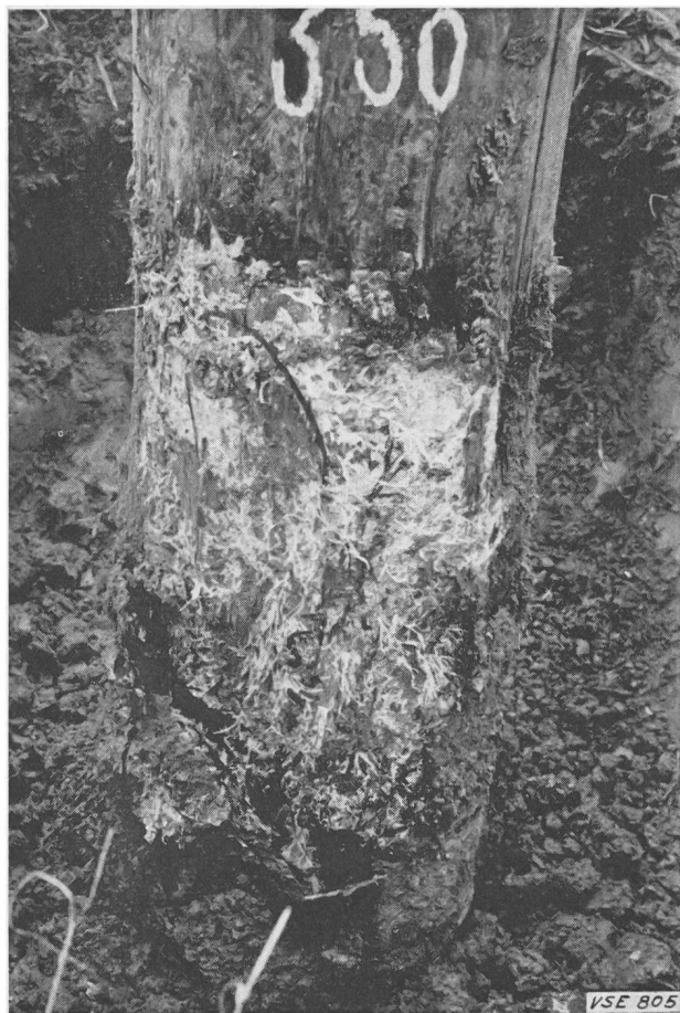
Fig. 4 Mit Ölanstrich nachgepflegte Stange, von Poria vaporaria befallen
