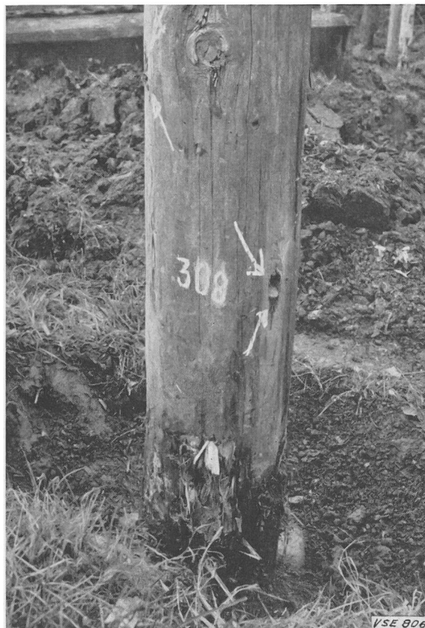
Fig. 5 Mit einem öligem Schutzmittel mittels Bohrlochtränkung nachgepflegte Stange, von Pilzen angegriffen
