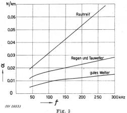
Verlauf der kilometrischen Dämpfung in Funktion der Frequenz
