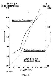
Anstieg der HF-Störspannung und der Koronaverluste  $P_v$  für einen bestimmten Leiter in Funktion der Feldstärke E an der Leiteroberfläche
