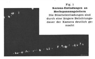
sicht auf den Leiterpreis, arbeitet man mit einer Stromdichte von  $j \approx 1~\mathrm{A/mm^2}$ . Grössere Leistungen lassen sich nur durch Erhöhung der Spannung übertragen. Für Leitungen mit 150-kV-Betriebsspannung und mehr treten bei den sich ergebenden Leiterdurchmessern weitere Verlustquellen in Erscheinung, nämlich die sog. Korona-Verluste. Übersteigt die Feldstärke an der Leiteroberfläche einen be-
