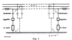
Schematische Darstellung des Ausbreitungsvorganges bei Einphasenkopplung
