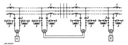
Fig. 10 Ausrüstung von 2 HF-Teilstrecken mit Zweiphasenkopplung, welche über eine Hochfrequenzbrücke verbunden sind
