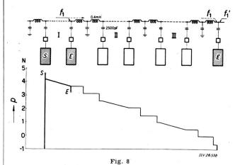
Schematische Darstellung des Pegelverlaufes p längs einer in mehrere Teilstrecken unterteilten Hochspannungsleitung
