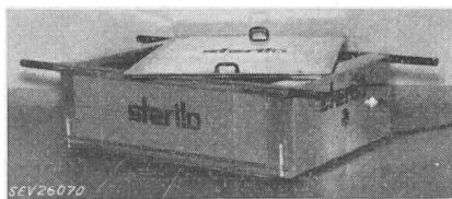
regler und Signallampe eingebaut. Traggriffe mit Gummi isoliert. Deckel mit Handgriffen aus Isolierpreßstoff. Ausziehbare Füsse ermöglichen Gebrauch des Apparates als Heizofen. Zuleitung verstärkte Apparateschnur mit 2 P + E-Stecker, durch Stopfbüchse eingeführt. Innenmasse des Rahmens 1200 x 900 x 410 mm.
