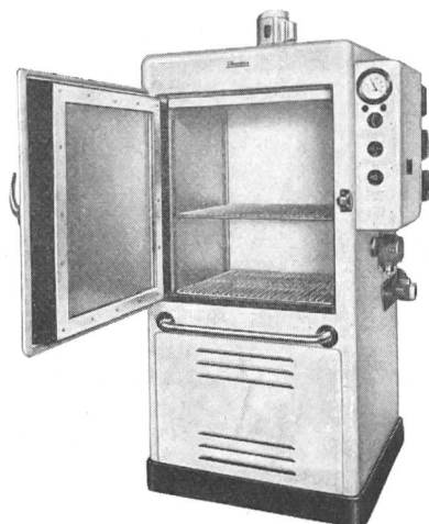
Fig. 4 «Therma»-Prüfschrank mit Temperatur- und Feuchtigkeitsregelung
