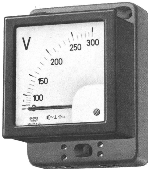
Fig. 1 Quadrant-Instrument 96 \times 96 mm mit Aufbausockel zur Montage hinter Türen von Schaltschränken
