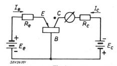
Fig. 1 Prinzipschaltbild eines Spitzentransistors
