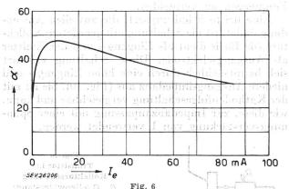
Stromverstärkung «'in Abhängigkeit des Emitterstromes I.
