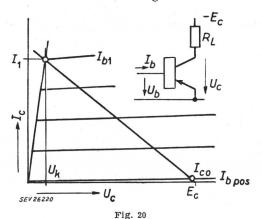
Idealisiertes Kennlinienbild des Transistors in der Emitterschaltung
