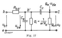
HF-Ersatzschema des Transistors
