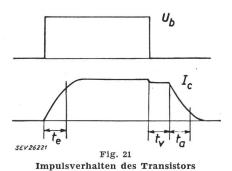
$U_b$  Spannungsimpuls an der Basis;  $I_o$  Stromimpuls im Kollektorkreis;  $t_e$  Einschaltzeitkonstante;  $t_v$  Verzögerungszeit;  $t_a$  Ausschaltzeitkonstante
