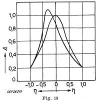
Verzerrung der Frequenzgangkurve als Folge der Kollektorkapazität einer HF-Verstärkerstufe A Frequenzgang; η Verstimmung links: verzerrte Kurve
