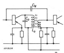
Fig. 18 Neutralisierter selektiver HF-Verstärker  $C_N$  Neutralisationskondensator;  $C_0$ ,  $L_0$  Schwingkreis
