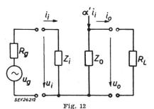
Vereinfachtes Ersatzschema des Transistors in Emitterschaltung  $I_i$  Eingangsstrom;  $I_o$  Ausgangsstrom;  $u_t$  Eingangsspannung;  $u_o$  Ausgangsspannung;  $u_g$  Quellenspanung des speisenden Generators;  $R_g$  Quellenwiderstand des speisenden Generators;  $R_L$  Belastungswiderstand;  $Z_i$  Eingangsimpedanz;  $Z_o$  Ausgangsimpedanz;  $Z_o$  Stromverstärkungsfaktor
