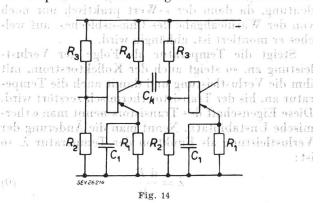
Transistorverstärker in Emitterschaltung mit RC-Kopplung  $R_1...R_4$ ,  $C_1$  Schaltelemente, die der Einstellung des Arbeitspunktes dienen;  $R_4$  Arbeitswiderstand im Kollektorkreis;  $C_k$  Kopplungskondensator
