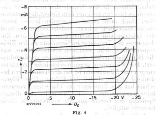
I<sub>o</sub>-U<sub>o</sub>-Kennlinienbild des Transistors in Emitterschaltung Bezeichnungen siehe Fig. 3
