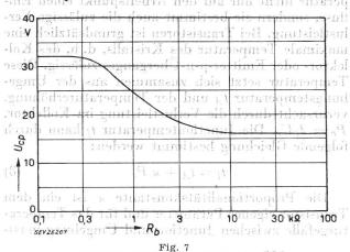
Maximal zulässige Kollektorspannung  $U_{ep}$  in der Emitterschaltung als Funktion des Widerstandes  $R_b$  im Basiskreis eines OC16-Transistors
