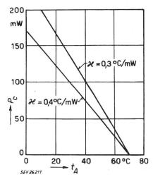
Fig. 11 Zulässige Verlustleistung  $P_o$  des OC72-Transistors in Abhängigkeit der Umgebungstemperatur  $t_A$ κ Wärmewiderstand
