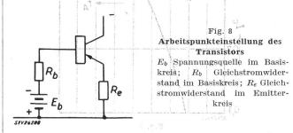
einen Spannungsteiler aus der Kollektorspeisespannung erzeugt, so ist es möglich, durch Anwendung des Theorems von Thévénin, diese Schaltung auf das Schema der Fig. 8 zurückzuführen. Der temperaturabhängige Nullstrom  $I_o$  im Kollektorkreis, d.h. der Strom  $I_c$  für  $E_b=0$  wird:
