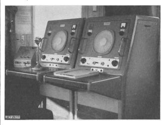
Fig. 14 Anzeigeapparatur der Gonio-Peilanlage im Kommandoturm
