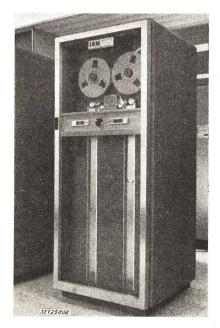
Fig. 8 Magnetbandeinheit
