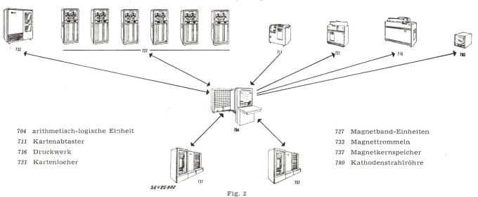
Schematische Übersicht über die einzelnen Einheiten
