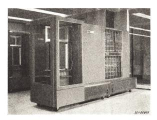
Fig. 5 Magnetkern-Speicher mit den Steuerschaltungen
