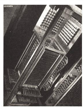
Fig. 4 Magnetkernspeicher mit 147 456 Magnetkernen
