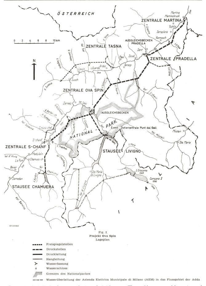
Der wenig oberhalb der Staumauer beginnende Druckstollen (lichter Durchmesser 2,30 m, Länge 7600 m, mit einem Baufenster im Val d'Arpiglia) führt zum Wasserschloss, von welchem ein rund 1050 m langer Druckschacht das Nutzwasser zu dem östlich von S-chanf im Freien gelegenen Maschinen-
