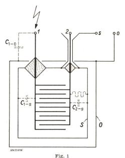
Aufbau des Normalkondensators
