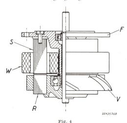
Flanschmotor für Einbau
