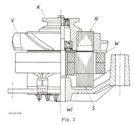
Einbaumotor mit angegossener Keilriemenscheibe, auf Wippe montiert zum Spannen des Riemens K Keilriemenscheibe; R Rotor; S Statoreisen; V Ventilator;
