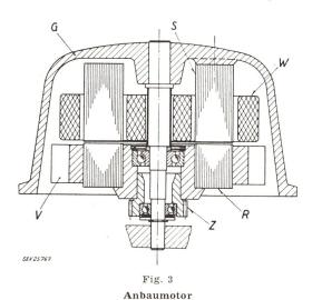
G Anbaugehäuse; R Rotoreisen; S Statoreisen; V Ventilator; W Statorwicklung; Z Zahnritzel
