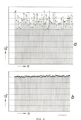
Streuung der Frontansprechspannung bei einer Steilheit von 100 kV/ $\mu s$  pro 10 kV Ableiternennspannung
