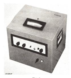
${\bf Fig.~1} \\ {\bf Stossvoltmeter} \\ {\bf zur~Scheitelwertmessung~von~einmaligen~Stosswellen}$
