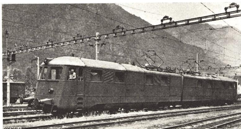
die der höchstzulässigen Zughakenbelastung entspricht. Bei einer Zughakenlast von 770 t und einem zugelassenen Achsdruck von 20 Tonnen musste eine solche Lokomotive mindestens 8 Triebachsen und ein Reibungsgewicht von 160 t erhalten.
