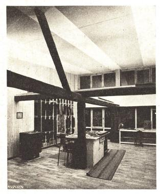
Fig. 9 Glasmaler-Atelier Rajsek in Boswil, Kt. Aargau Indirekt-Beleuchtung mit Fluoreszenzlampen, auf Balken montiert.  $4\times40~{
