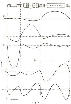
Kritische Drehzahlen einer Turbine 1 Hochdruckturbine; 2 Niederdruckturbine; 3 Generator
