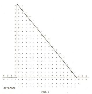
Gitter für die Berechnung der Spannungen in einer Staumauer unter Berücksichtigung der elastischen Einbettung in den Baugrund
