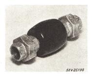
Das Isolierzwischenstück hat die Prüfung gemäss den Richtlinien für Tankanlagen, aufgestellt vom Eidg. Amt für Verkehr, Bern, bestanden. Verwendung: Zur Fernhaltung von Fremdströmen in Tankanlagen.
