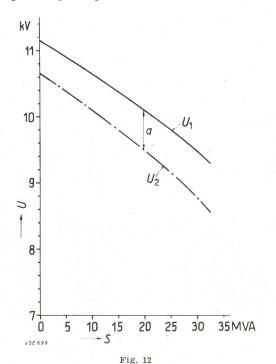
Spannungsverlauf an den 10-kV-Sammelschienen des Unterwerkes Luterbach in Funktion der Belastung, bei  $\cos \varphi = 0.8$
