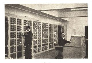
Das Netzmodell der «Tablelec» in Brüssel Die Netzbelastungen werden gerade eingestellt
