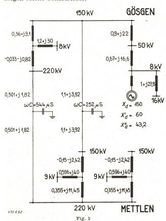
Ausschnitt aus dem Netzplan für die Impedanzen des Mitsystems
