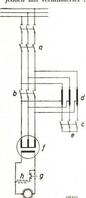
lasstransformator d angeworfen. Die Rotoroder Erregerwicklung ist während dieses Vorganges über einen Ohmschen Widerstand h kurzgeschlossen, wodurch der Leistungsfaktor des Rotorstromes und damit das Anlaufmoment verbessert wird.
