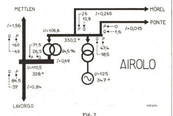
Ausschnitt aus dem Netzplan mit den für einen bestimmten Fall am Netzmodell gefundenen Messwerten
