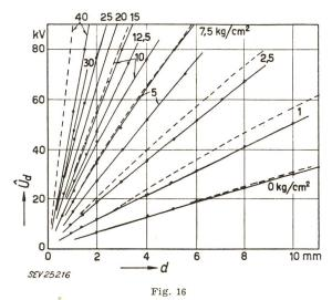
Durchschlagspannung zwischen ebenen Platten in Stickstoff  $\mathcal{D}_d$  in Funktion des Plattenabstandes d bei variablem Druck
