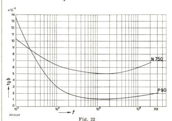
Anderung des Verlustfaktors tg  $\delta$  in Funktion der Frequenz f bei den Massen N 750 und P 90
