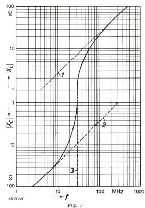
Verhalten eines Glimmerkondensators in der Umgebung der Resonanzfrequenz
