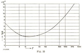
Anderung des Verlustfaktors tg  $\delta$  in Funktion der Frequenz f eines mit Kunstharz umgossenen Glimmerkondensators Betriebsdaten: 400 pF, 24 kV Gleichspannung bzw. 6 kV HFSpannung
