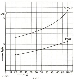
Anderung des Verlustfaktors tg  $\delta$  in Funktion der Temperatur  $\vartheta$  bei den Massen N 750 und P 90
