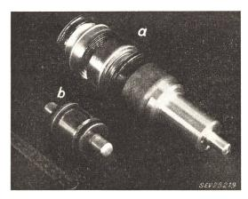
Fig. 19 Variabler a und fester b Vakuum-Kondensator
