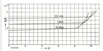
Fig. 8 Verlustfaktor tg  $\delta$  eines 60-pF-Scheibenkondensators in Abhängigkeit von der Spannung U bei verschiedenen Frequenzen
