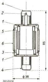
Fig. 18 Schnitt durch einen Vakuumkondensator
