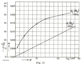
Durchschlagspannung  $\hat{U}_d$  und Dielektrizitätskonstante  $\epsilon$  eines Pressgaskondensators in Funktion des Druckes p bei 1 MHz
