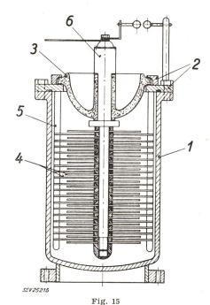
Schnitt durch einen Pressgaskondensator 1 Kondensatorkübel; 2 Kondensatordeckel; 3 Isolator; 4 Kondensatorplatten; 5 Plattenhalter
