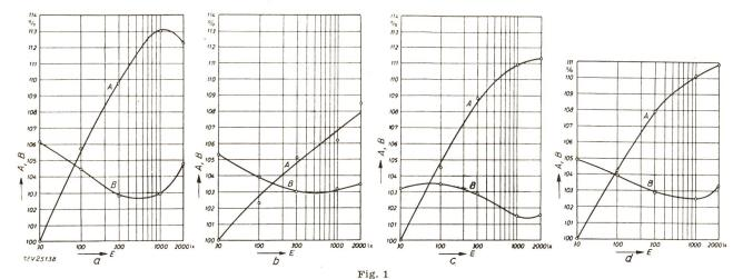
Relative Arbeitsleistung und relative Ermüdung bei verschiedenen Beleuchtungsarten a bei Glühlampenlicht; b bei Quecksilberdampflicht; c bei Fluoreszenzlicht; d Mittelwert bei allen drei Beleuchtungsarten; A relative Arbeitsleistung; B relative Ermüdung; E Beleuchtungsstärke
