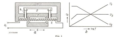
Elektromagnetischer Transduktor eines Vibrationsmessgerätes mit Übertragungs-Charakteristiken
