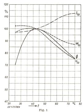
Lichtstrom  $\Phi$  einer TL-40-W-Fluoreszenzlampe in Abhängigkeit von der Wandtemperatur
