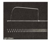
Fig. 5 Nach 9 μs abgeschnittene Stosswelle Eichfrequenz 2 MHz
