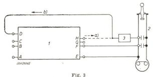
Schaltung: Repetitions-Stossgenerator mit Kathodenstrahl-Oszillograph
