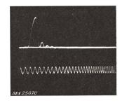
Fig. 11 Stosswelle des Holzspaltens Eichfrequenz 2 MHz
