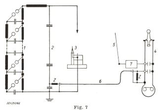
Schaltung: Hochspannungs-Stossgenerator mit
