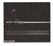
Fig. 10 Stosswelle des Stützerüberschlages Eichfrequenz 2 MHz
