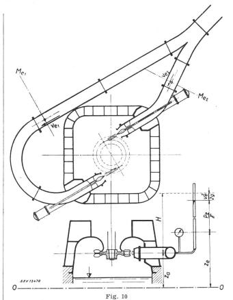
Gleichdruckturbine Zweidüsig. Vertikale Welle
