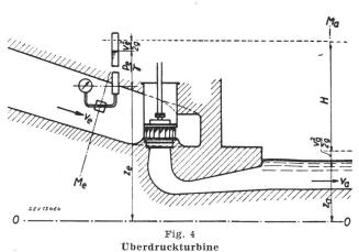
Geschlossene Betonspirale. Vertikale Welle. Saugrohrkrümmer Nutzgefälle  $H=z_e-z_a+rac{p_e}{\gamma}+rac{v_e^2-v_a^2}{2\;g}$
