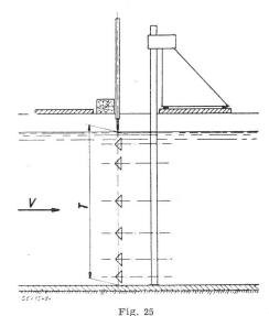
Messung der Wassertiefe im Flügelmessquerschnitt mit Stechpegeln
