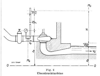
Spiralgehäuse. Vertikale Welle. Saugrohrkrümmer
