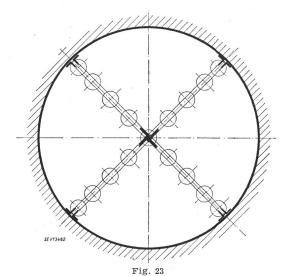
Flügelmessung in Rohrleitungen mit grossem Querschnitt Flügeltragkreuz mit fest eingebauten Flügeln
