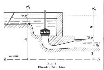
Offene Wasserkammer. Vertikale Welle. Saugrohrkrümmer  ${\rm Nutzgef\"{a}lle}~H=z_{\it e}-z_{\it a}+\frac{v_{\it e}^2-v_{\it a}^2}{2\,\it g}$
