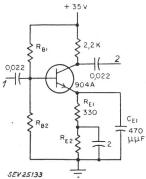
Fig. 1 Bildverstärkerstufe mit geerdetem Emitter
