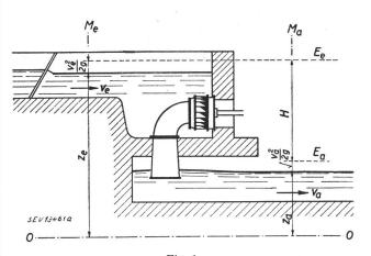
Fig. 1 Überdruckturbine (Francis, Propeller, Kaplan) Offene Wasserkammer. Horizontale Welle. Blechsaugrohr Nutzgefälle  $H=z_e-z_a+\frac{v_e^2-v_a^2}{2}$
