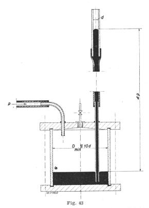
Druckmessung: Quecksilber-Druckmesstopf mit Steigrohr p Druckzuleitung; d Lichter Durchmesser des Piezometer-Glasrohres;  $\Delta p$  Druckhöhe
