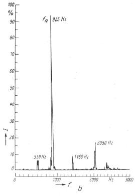
Geräuschanalyse eines 1stufigen Turbinengetriebes und Radkörper-Resonanzspektrum
