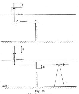
Überfallmessung Einstellung des Stechpegel-Nullpunktes mit Wasserwaage (oben) oder Nivellierinstrument (unten)
