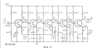
5stufiger Verstärker mit gleicher Frequenzgangkorrektur in jeder Stufe
