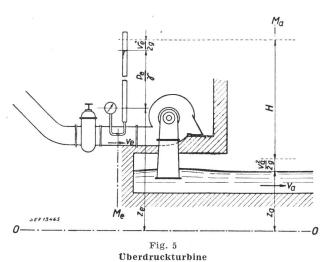
Spiralgehäuse. Horizontale Welle. Blechsaugrohr
