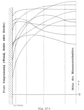
Verschiedene typische Geschwindigkeitskurven an Wand, Sohle oder Decke von verhältnismässig engen Messquerschnitten
