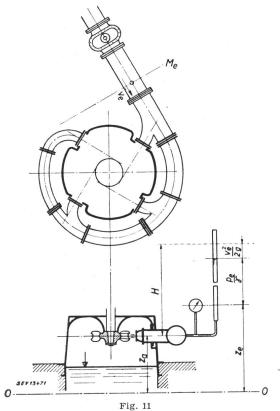
Gleichdruckturbine Mehrdüsig. Vertikale Welle
