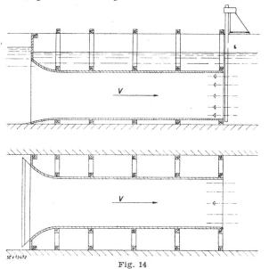
Provisorische Messdüse mit quadratischem oder rechteckigem Querschnitt
