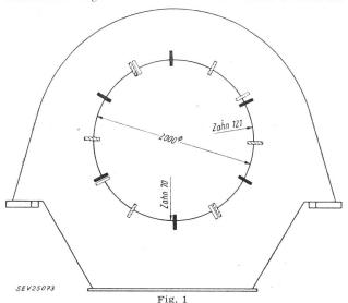
Knotenlagen für Biege-Eigenchwingungen des Stators eines Aynchronmotors bei punktförmiger Erregung
