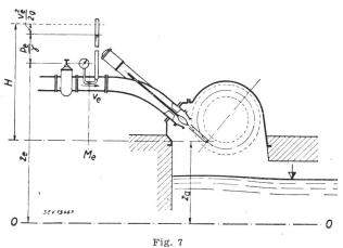
Gleichdruckturbine (Freistrahl, Pelton)
