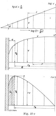
Geschwindigkeitsverlauf in der Randzone einer Rohrleitung nach dem Ansatz in Ziff. 93 y
