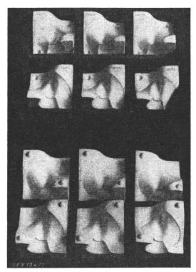
Fig. 18 Gipskontrollformen für Wassermessflügel
