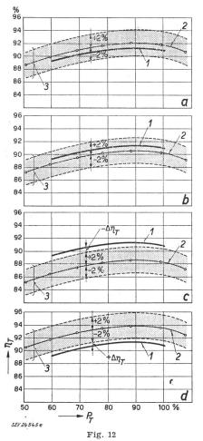
Vergleich der Messergebnisse mit den Garantiewerten und Anwendung der Messtoleranz auf den Wirkungsgrad
