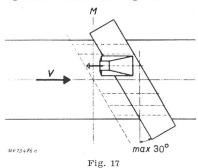
Gestaffelte Anordnung: Flügelmessquerschnitt nicht senkrecht zur Strömungsrichtung
