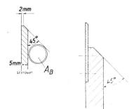
Fig. 32  ${f Uberfallmesswand}$  Ausbildung der  ${f Uberfallkante}$  und Lage des Belüftungsquerschnittes  $A_B$
