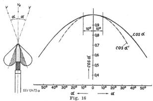
Abweichung der Flügeleichkurve vom Cosinus-Gesetz bei schräger Anströmung des Flügels
