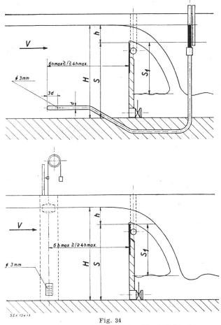
Einrichtungen zur Messung der Überfallhöhe h Piezometer mit horizontaler Druckmessleitung unten: Seitlicher Schwimmerschacht. Anschluss mit Lochblech
