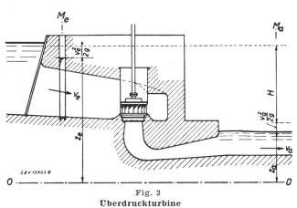
Geschlossene Betonspirale. Vertikale Welle. Saugrohrkrümmer  ${\rm Nutzgefälle}~H=z_s-z_a+\frac{v_e^2-v_a^2}{2~g}$
