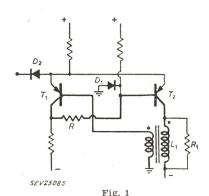
Prinzipschema des bistabilen Kippers mit Flächentransistoren In der Schaltung wurden keine Kondensatoren verwendet, wodurch sich das grosse Auflösungsvermögen von 2 us ergibt Bezeichnungen siehe im Text
