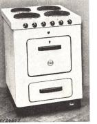
Kochherd gemäss Abbildung, mit 4 Kochstellen, Backofen und Schublade. Feste Herdschale aus emailliertem Blech. Platten von 180 und 220 mm (drei Stück) Durchmesser mit Rand aus rostfreiem Stahlblech, fest montiert. Backofenheizkörper ausserhalb des Backraumes angeordnet. Anschlussklemmen für verschiedene Schaltungen eingerichtet. Handgriffe aus Isoliermaterial.
