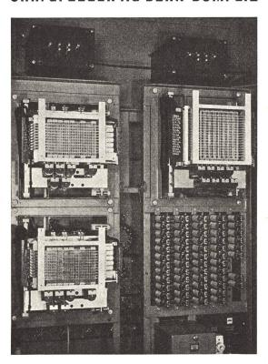
Verwendung des Kreuzwählers in Fernsteueranlagen
