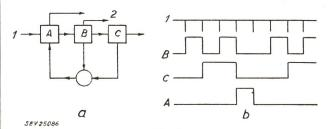
Fig. 2 Blockschaltbild des Fünfschrittzählers (a) und Impulsdiagramm (b) dazu
