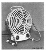
Heizlüfter «Astron 2000» gemäss Abbildung, als Ventilator und Heizofen verwendbar. Widerstandswendel auf sternförmigem Träger aus Glimmer befestigt. Ventilator angetrieben durch selbstanlaufenden Einphasen-Kurzschlussankermotor. Betrieb des Apparates mit Kalt-, Warm- und Heissluft bei 4 verschiedenen Drehzahlen des Ventilators möglich. Bei blockiertem Motor wird die Heizung durch einen eingebauten Temperaturschal-
