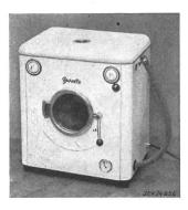
Waschmaschine gemäss Abbildung, mit Heizung. Laugebehälter aus galvanisiertem Eisenblech mit unten eingebautem Heizstab. Wäschetrommel aus vernickeltem Kupfer, führt Drehbewegungen in wechselnder Richtung aus. Umsteuerung durch Wendeschalter. Antrich durch Einphasen-Kurzschlussankermotor mit Hilfswicklung und dauernd eingeschaltetem Kondensator. Zeitschalter für Motor und Heizung,
