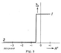
Charakteristik eines einzelnen Magnetverstärkers U' relative Ausgangsspannung; H' relatives angelegtes Feld; 1 «Ein»; 2 «Aus»
