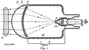
Schematische Darstellung der Bildverstärkerröhre O Objekt; D Träger von Röntgenschirm R und Photokathode K A Anode; Fl Betrachtungsschirm; M Mikroskop
