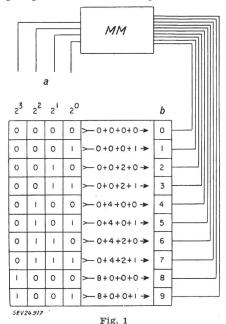
Duale Verschlüsselung der Ziffern 0...9 für den Übergang von der verschlüsselten auf die entschlüsselte Darstellung MM Magnetmatrize; a 4-Ziffer-Eingang (binäre Signale); b Dezimal-Ausgangsanzeige
