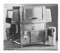
schlussankermotoren. Heizstäbe für Tankheizung. Schaltschütze mit thermischer Auslösung, Schalter für Heizung und Motoren, Signallampen und Sicherungselemente eingebaut. Heisswasserspeicher mit Temperaturregler und angebautem Schaltschütz. Gehäuse der Maschine aus rostfreiem Stahl. Handgriffe isoliert. Maschine für festen Anschluss der Stromzuführungen und Wasserleitungen eingerichtet.
