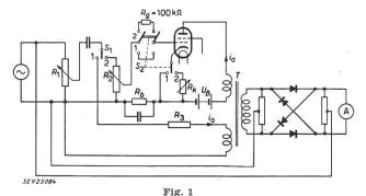
Schaltschema des Röhrenprüfgerätes
