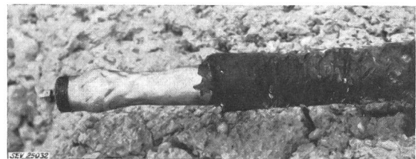
Fig. 12 Durch Ziehen mit einem Kabelstrumpf deformierter Kabelkopf
