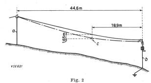
10-kV-Leitung zur Transformatorenstation Stechlenegg mit Telephonkreuzung
