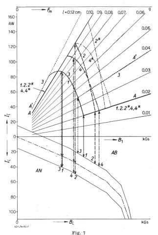
Die Möglichkeiten zur Beeinflussung der Gleichgewichtskurve Veränderung von Federvorspannung  $l_{\rm o}$ , Federkonstante k, Arbeitsluftspalt  $l_{min}$
