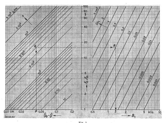
Darstellung der auf den Anker wirkenden magnetischen und elastischen Kräfte (Alle Kräfte auf die Mitte des Hauptluftspaltes bezogen)
