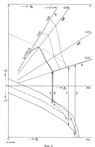
Einflüsse der Kontaktfedern und der unvollständigen Eisensättigung auf den Abfallstrom
