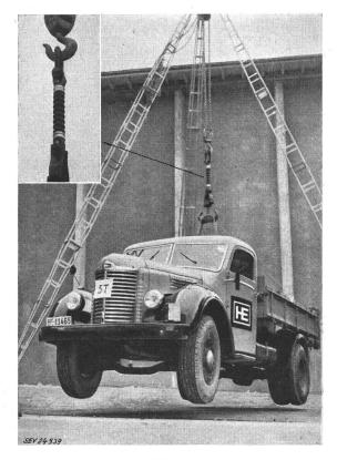
Fig. 1 Langstabisolator mit 5 t auf Zug beansprucht
