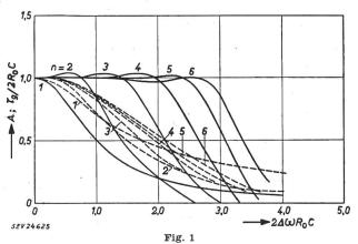
Amplituden und Gruppenlaufzeitkurven eines Breitbandverstärkers mit n versetzten Kreisen
