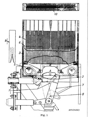
Querschnitt durch einen 500-MVA-Magnetschalter Die Linien A, B, C und D zeigen den zeitlichen Verlauf des Lichtbogens
