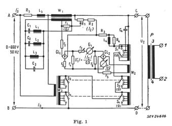
Prinzipschema der n-Messeinrichtung
