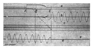
Fig. 2 Oszillogramm einer einphasigen Ausschaltung bei voller Leistung
