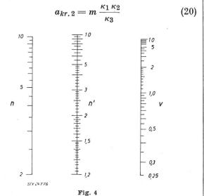
Nomogramm zur Bestimmung des Gewichtsverhältnisses n'zwischen dem n-fach belasteten und dem normal zusätzlich belasteten Seil
