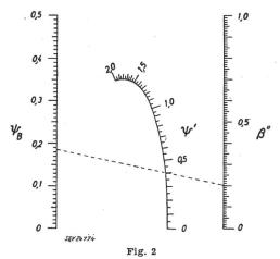
Nomogramm zur Ermittlung des Hilfswertes  $\psi'$   $\beta''$ ,  $\psi'$  und  $\psi_B$  Hilfswerte nach besonderer Definition
