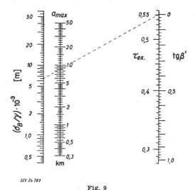
Nomogramm zur Ermittlung der Grösstspannweite  $\sigma_B$  höchstzulässige Spannung im höheren Aufhängepunkt in kg/mm²;  $\gamma$  bezogenes Leitergewicht mit Zusatz in kg/m·mm²; tg $\beta$ ′ Tangentenneigung in Feldmitte;  $\tau_{ex}$ . Hilfswert nach besonderer Definition
