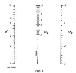
Nomogramm zur Ermittlung des Hilfswertes  $\kappa_3$  n' Gewichtsverhältnis des n-fach belasteten Seils zum normal zusätzlich belasteten Seil;  $\kappa_2$  und  $\kappa_3$  Hilfswerte nach besonderer Definition
