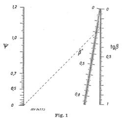
Nomogramm zur Bestimmung des Hilfswertes  $\beta''$   $tg\beta$  Feldneigung;  $\psi$  Feldkenngrösse;  $\beta''$  Hilfsgrösse nach besonderer Definition
