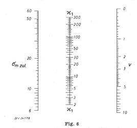
Nomogramm zur Ermittlung des Hilfswertes  $\kappa_1$  v Verhältnis der Zusatzlast zum Eigengewicht;  $\sigma_{m\ zul.}$  im Durchhangspunkt zulässige Spannung in kg/mm² bei normaler Sicherheit;  $\kappa_1$  Hilfswert nach besonderer Definition
