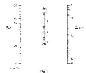
Nomogramm zur Bestimmung des Hilfswertes  $\kappa_2$   $\sigma_{m \, zu \, l}$  bzw.  $\sigma_{m \, D}$  im Durchhangspunkt zulässige Spannungen in kg/mm² bei normaler bzw. einfacher Sicherheit;  $\kappa_2$  Hilfswert nach besonderer Definition
