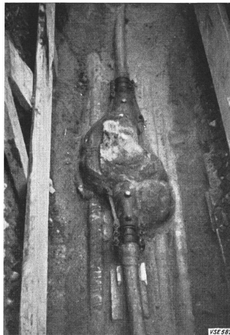
Fig. 7 Verbindungsmappe mit ausgeweiteter Kabel-Füllmasse zufolge Bruch des Bleimantels
