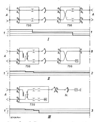
$3^e$  cas. Lors de l'occupation par une ligne à basse tension (2 fils — 4 fils) le fil de test  $c_2$ , NF. Connexion de l'équilibreur.
