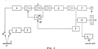
Blockschema eines Hochfrequenz-Höhenmessers mit Frequenzmodulation
