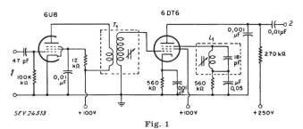
Die Schaltung des neuen FM-Detektors mit der Röhre 6DT6
