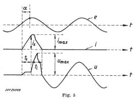
Beispiel der Prüfung einer Sicherung der Klasse 200 A-2-G4 Prüfung mit 20 kA bei 550 V mit einem Einschaltwinkel von 60°
