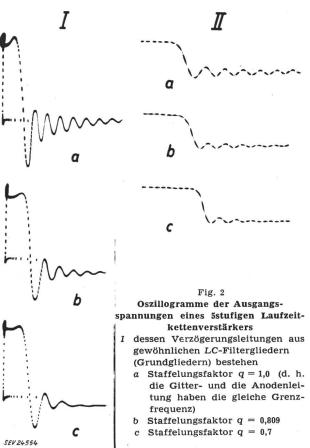
II dessen Verzögerungsleitungen aus m-abgeleiteten (Zobel-) Filtergliedern bestehen, wobei die m-Werte der beiden Leitungen verschieden kombiniert sind
