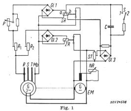
Prinzipschaltung des untersuchten Kontaktreglers EM Erregermaschine; Gl. 1, 2, 3 Gleichrichter; SR Spannungsrelais; ZR Zwischenrelais; NR Nebenschlussregler; S Schalter; P, ST Potentiometer;  $R_1$ ,  $R_2$  fest eingestellte Widerstände
