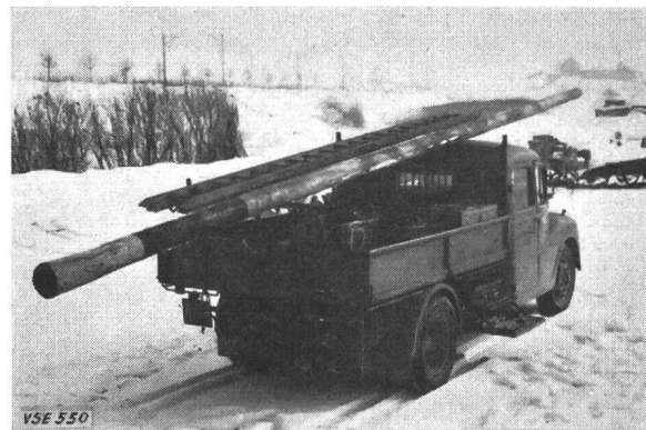
Fig. 6 Lastwagen der Fig. 2: Stangentransport mit Aufsatz
