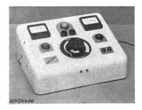
mit 2 P + E-Stecker, durch Stopfbüchse eingeführt. Kontaktbüchsen für den Anschluss der Badeelektroden.
