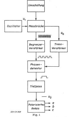
Blockschema des automatischen Sortiergerätes
