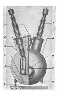
Fig. 1 Schnitt durch einen Pol, gültig für alle Konstruktionen von 138 kV bis 330 kV
