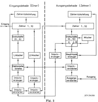
Blockschema eines Frequenzteilers über zwei Dekaden
