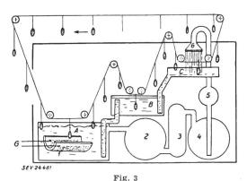
Schema einer vollautomatischen Ultraschallreinigungsapparatur für Gegenstände ungefähr gleicher Grösse
