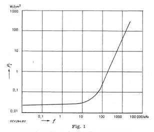
Schallintensität  $P_4$  in Funktion der Frequenz fP, ist die minimale Schallintensität, die zur Erzeugung von Kavitation in Wasser mit normalem Gasgehalt nötig ist
