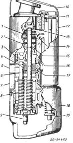
Fig. 2 Schnitt durch einen Zweiserie-Unterbrecher, welcher für 138 kV, 161 kV und 230 kV verwendet wird
