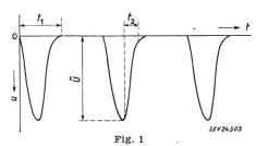
Eingangssignale des Frequenzteilers
